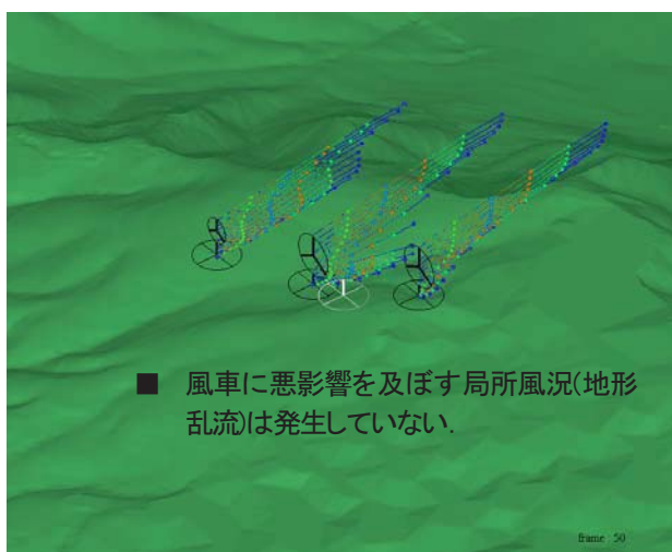
(c)無次元時刻 t=2 \times \Delta t 後 図-9 各々の風車位置から放した仮想粒子の軌跡(時間経過の様子)
